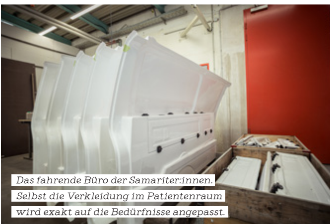
Passender Druck & Hitze. Die Formteile werden direkt im Werk in Tulln gepresst.
